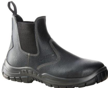
Podešev PU/ guma je nepíšící, antistatická, odolná proti olejům, pohonným hmotám a kontaktnímu teplu do 300 °C. Obuv se zvýšenou ochranou špice a patní části a s poutkem pro snadné nazouvání. V oblasti kotníku bezpečnostní boční vsadky z kombinace gumy a textilie pro okamžité vyzutí v případě vniknutí okuje do obuvi. Obuv je vhodná pro použití ve slévárenství.
