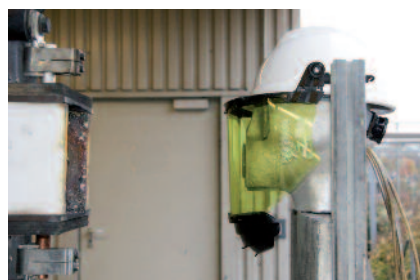
Uspořádání testu ochrany hlavy MSA el. obloukem před testem typu „Arc-in-the-Box“ proudem 7 kA
