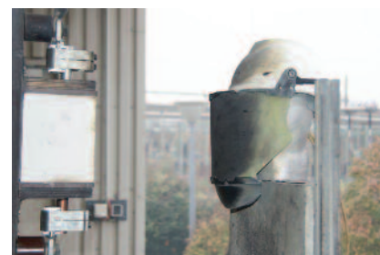
Test podle normy GS-ET-29 třída 2-7 kA byl úspěšně absolován. Kombinace ochrany hlavy a obličeje chrání nositele
