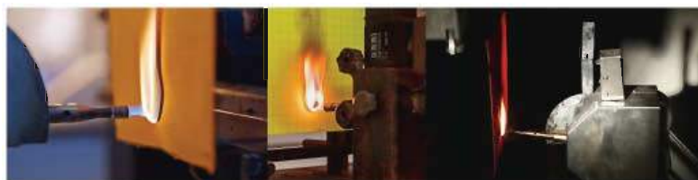
Obmedzenie šírenia plameňa, metodika ISO 1502 Limited flame spread, methodology ISO 1502
