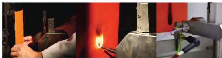
Obmedzenie šírenia plameňa, metodika ISO 1502 Limited flame spread, methodology ISO 1502
